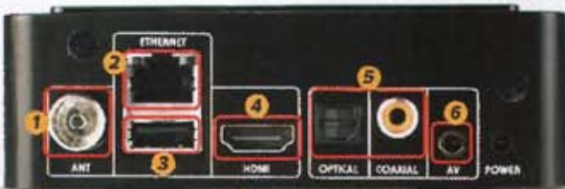
Detrás tiene la toma de antena 1, la conexión ethernet 2, un USB Host 3, la salida HDMI 4, las salidas de audio digital 5 y la de video compuesto 6.
